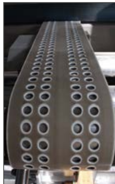
Изготовление плоских ремней на заказ: с перфорацией, перегородками, направляющими, покрытиями и т.д.
