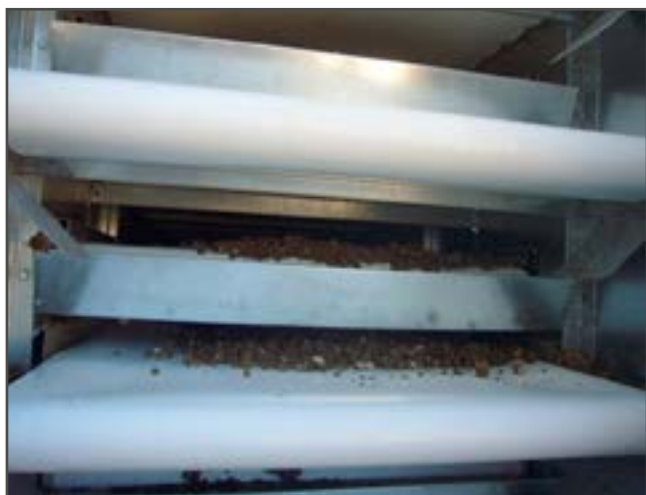
Лента для пометоудаления из ПП. Поставляется в рулонах. Ширина и длина определяются заказчиком.
