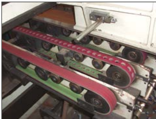
Плоские ремни с покрытием и/или отверстиями для прецизионной подачи картонажных изделий.
