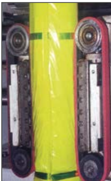
Зубчатые ремни с покрытием для вертикальных упаковочных машин.
