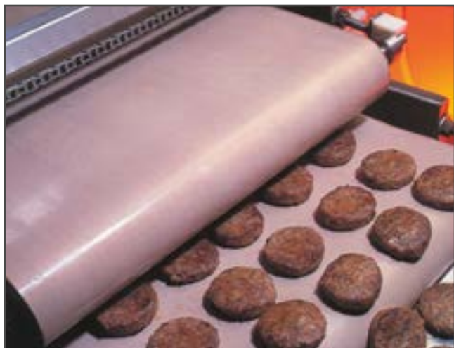
Транспортерные ленты из стекловолокна с тефлоновым покрытием. Обладают антипригарными свойствами и устойчивы к температурам до 260°C.
