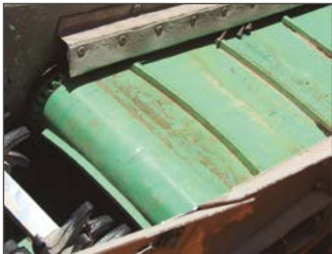
Специальные ленты для уборки винограда, с перегородками, внутренними направляющими и боковыми оградительными щитками.
